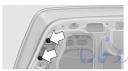
Inside brake lamp 21-watt bulb, H21W.
